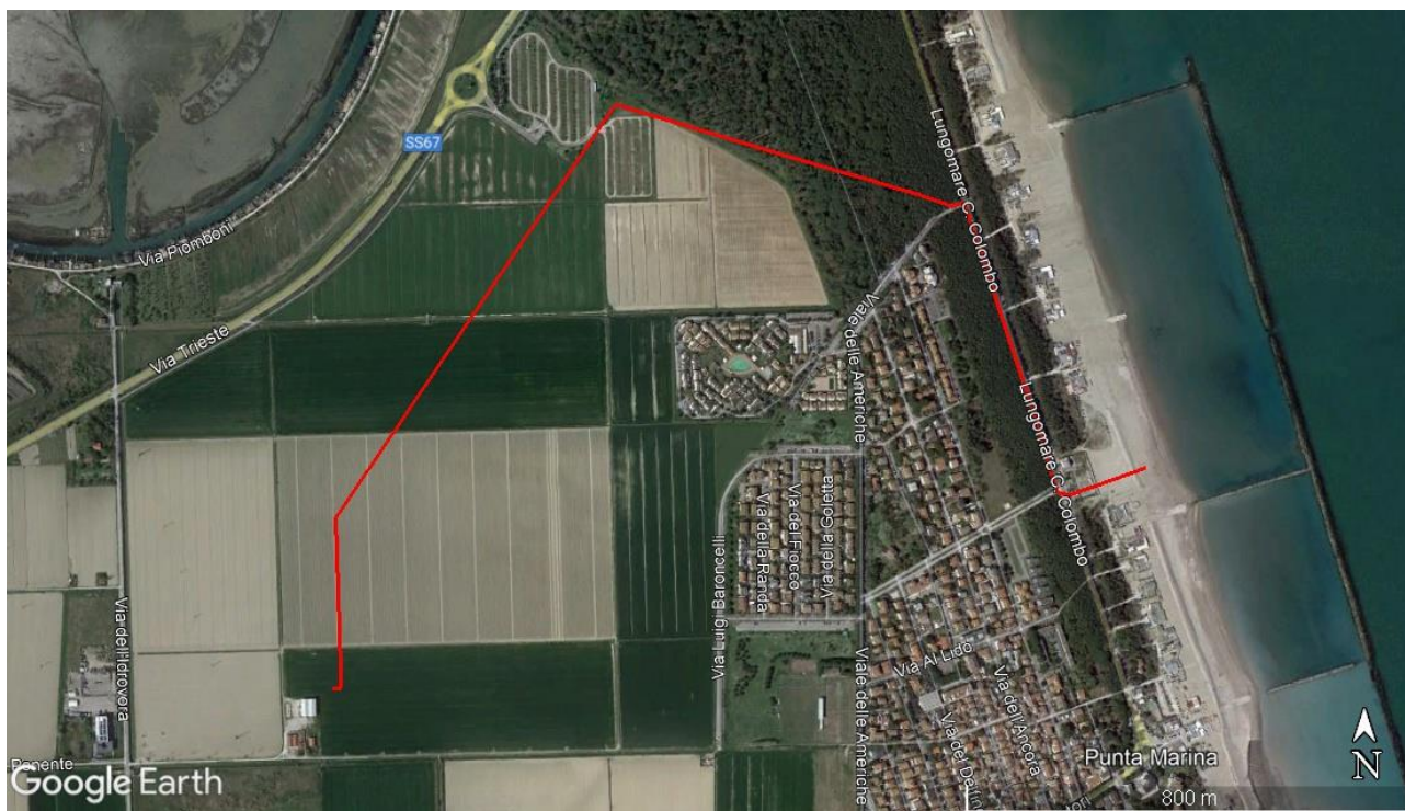
Figura 1: sviluppo lineare del tratto di condotta a terra DN 650(26'') – DP 100 barg lunga circa 2,5 km tra l'area ex-SAROM e l'impianto trappole previsto all'interno dell'area impianto PDE a Punta Marina (RA)
